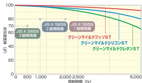
●キセノンランプでの促進耐候性試験により塗膜の光沢保持率の変化を測定しました。塗膜は劣化が進むと光沢を失います。このことから、光沢保持率の高い塗料は耐久性が高いと言えます。
