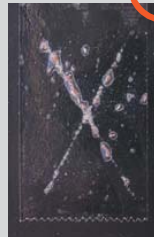
■剥がしたセロハンテープに付着した塗膜の状況で判断(暗色系の下地の上に置く)
