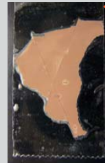
■剥がしたセロハンテープに付着した塗膜の状況で判断(暗色系の下地の上に置く)
