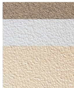
厚付け仕上げ (下地のパターンを変える)
